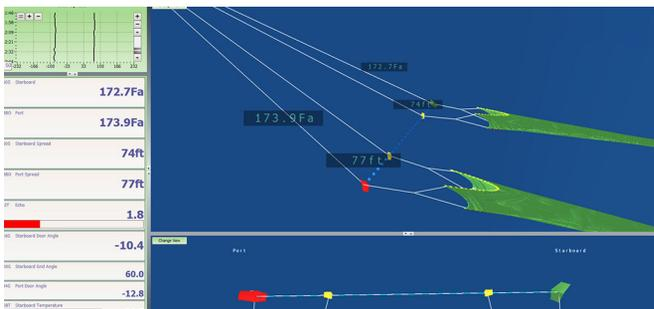
Los sensores de Profundidad indican la distancia desde la Superficie hasta las puertas o el aparejo donde está instalado el sensor.
